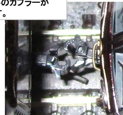
マグネティックナックルカプラーとは、左の画像の様に、ナックルカプラーに解放ピンがついているカプラーです。このカプラーを装着した車両同士を、アンカプラー線路(品番:20-032)上で停車する事により、自動解放が楽しめます
